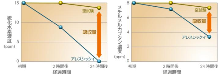
※アレスシックイ塗装板を5Lテドラーパーグにセットし、一定濃度の硫化水素又はメチルメルカプタン含有空気を封入し系内の該化合物濃度を測定。
